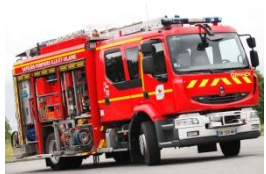
Fourgon Pompe Tonne Secours Routier – FPTSR (engin polyvalent incendie et secours routier)
